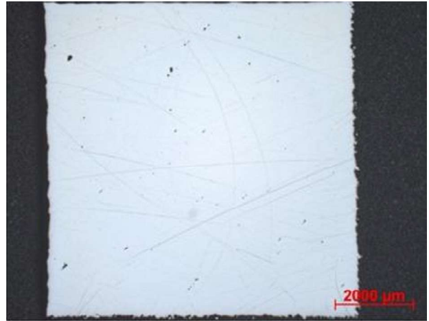
Slika 12: Vzorec kocke, izdelane iz recikliranega prahu Co-Cr, parametri tiskanja: moč 70 W, hitrost laserja 520 mm/s.
