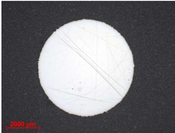
Slika 9: Vzorec valjčka, izdelanega iz novega prahu Co-Cr. Parametri tiskanja: moč laserja 70 W, hitrost laserja 520 mm/s.
