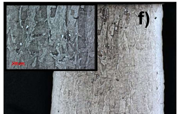
Slika 2: Prikaz mikrostrukture v prečnem in vzdolžnem preseku ulitega zatička (levo) in zatička, izdelanega po postopku SLM (desno) iz zlitine Co-Cr. Posnetek a je uliti zatiček pri manjši povečavi, opazovan s svetlobno mikroskopijo; b in c – jedkana površina ulitka pri večjih povečavah; d – 3D-natisnjeni zatiček pri manjši povečavi, opazovan s svetlobnim mikroskopom; e prečni in f – vzdolžni prerez 3D-tiskanega zatička po jedkanju.
