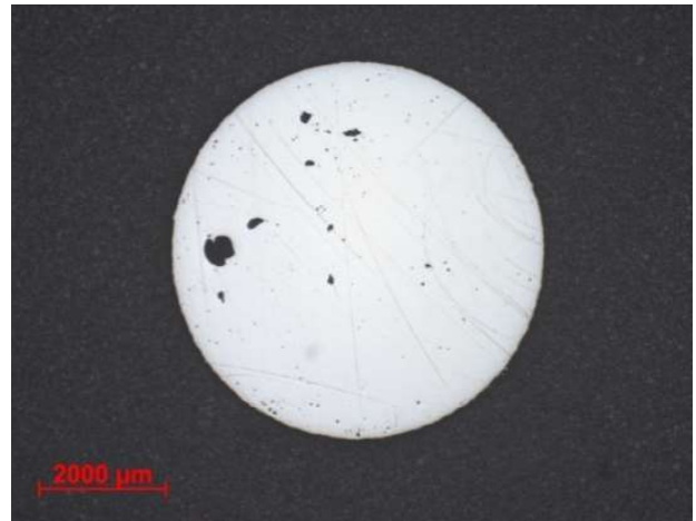
Slika 10: Vzorec valjčka, izdelanega iz recikliranega prahu Co-Cr. Parametri tiskanja: moč laserja 70 W, hitrost laserja 520 mm/s.
