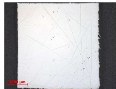
Slika 6: Metalografski prerez vzorca Co-Cr, tiskanega z gostoto energije laserja 208,8 J/cm 3 (moč: 95 W, hitrost tiskanja: 520 mm/s).
